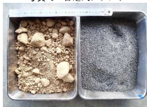
写真-4 材料（左：建設発生土，右：熔融スラグ）
