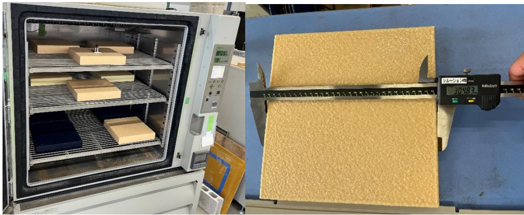
写真-4 浮力材試験（左：試験体設置風景，右：試験体寸法確認，寸法・外観変化なし）
